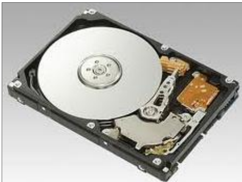
Slika 12: Pogled v notranjost trdega diska: plošče in bralno-pisalne glave
