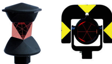
Slika 50: Primeri optičnih prizem
