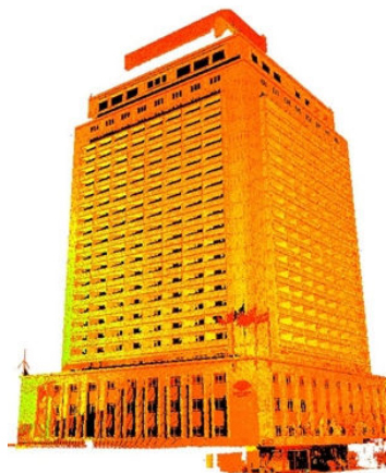
Slika 53: Primer podatkov, pridobljenih s terestričnim 3D skenerjem
