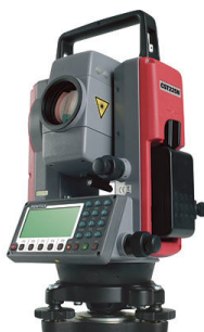
Slika 51: Primer elektronskega tahimetra
