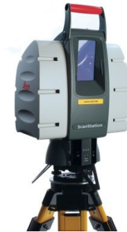
Slika 52: Primer 3D skenerja
