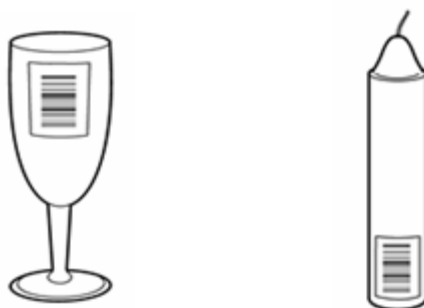
Slika 68: Primer namestitve črtne kode na cilindričnih izdelkih Vir: Uporabniški priročnik, 2009, 23
