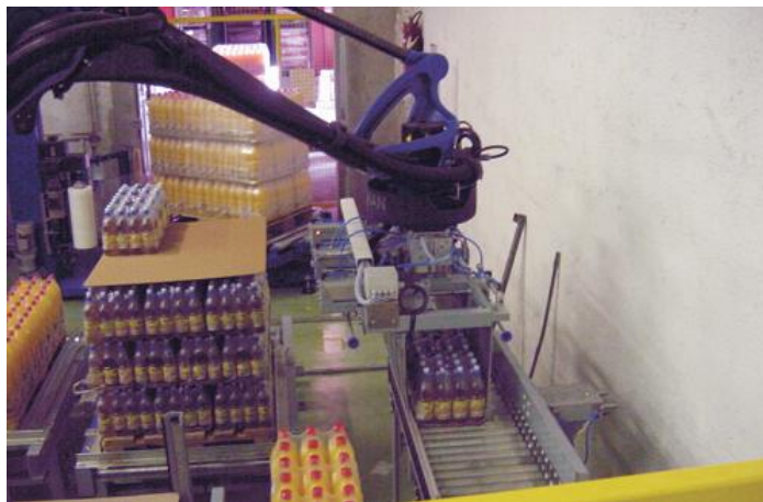
Slika 51: Avtomatizirano pobiranje polnih sodov iz valjčnega transporterja Vir: http://www.pakman.si/upload/pdf/83194499602541328.pdf (16. 2. 2011)
