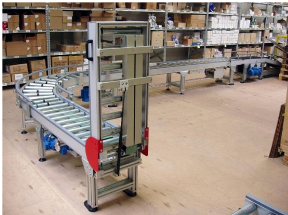
Slika 42: Valjčni transporter z elektromotorjem
