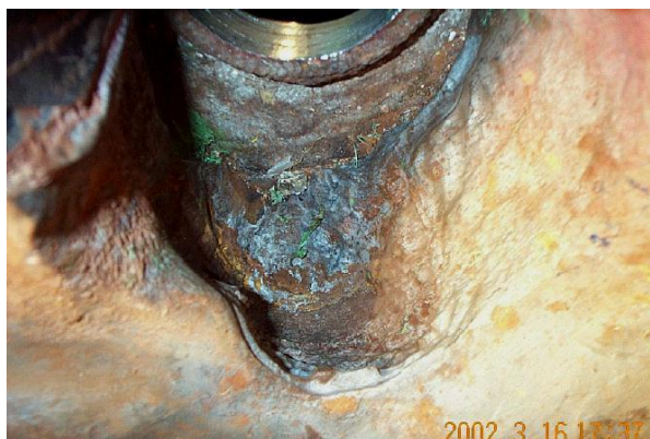
Slika 52: Kavitacija na reaktorju
