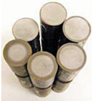
Slika 38: Različne globine cementacije
