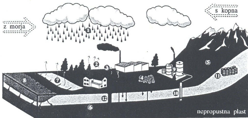
Slika 19. Najbolj pogosti primeri onesnaženosti podtalnice Vir: E. Petrešin, Vodovod in kanalizacija , Ljubljana 1999
