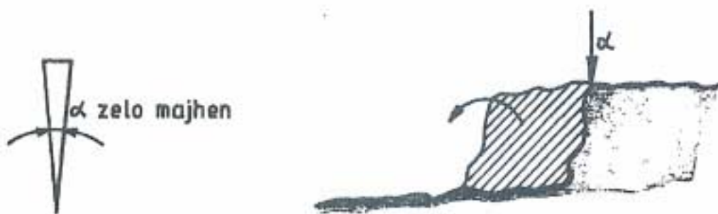
Slika 3/8: Pridobivanje blokov s pomočjo klinov
