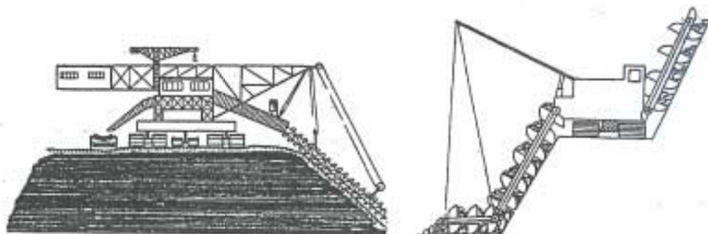
Slika 3/14: Bager vedričar- kombinirani, s členkasto lestvijo
