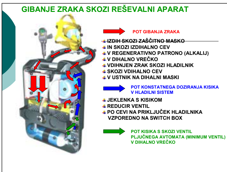
Slika 10/5: Gibanje zraka skozi Dräger BG-4
