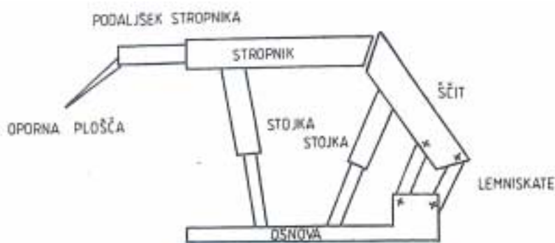
Slika 8/20: Shematski sestav sekcije hidravličnega podporja
