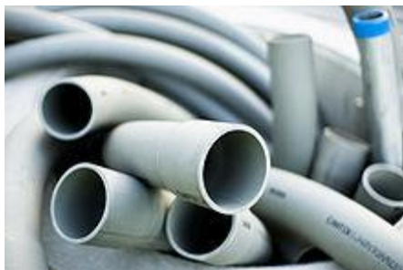
Slika 10: Plastične cevi iz polivinilklorida Vir: sl.wikipedia.org/wiki/Plastika , (12. 4. 2011)
