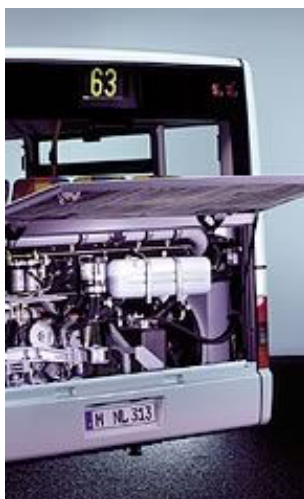
Slika 3.29: Vgradnja motorja v avtobusu Vir: www.iveco.com , www.man.com
