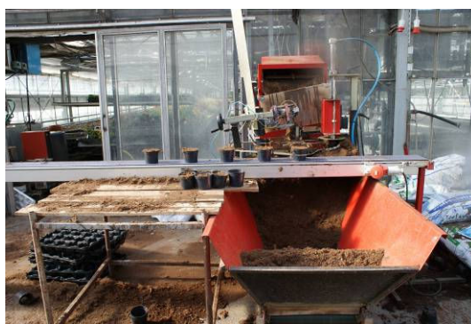
Slika 49: Stroj za polnjenje lončkov, Vrtarnarija tipa A, 2008 Vir: Lasten
