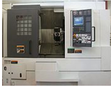
Abb. 15: Moderne CNC-Drehmaschine, in diesem Fall auch zum Bohren geeignet Quelle: http://de.wikipedia.org/wiki/CNC-Drehmaschine (20. 5. 2009)
