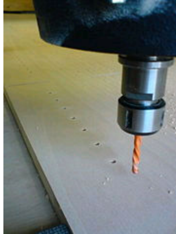
Abb. 14: Bohren einer Lochreihe auf einer Portalfräsmaschine Quelle: http://de.wikipedia.org/wiki/CNC-Maschine (19. 5. 2009)
