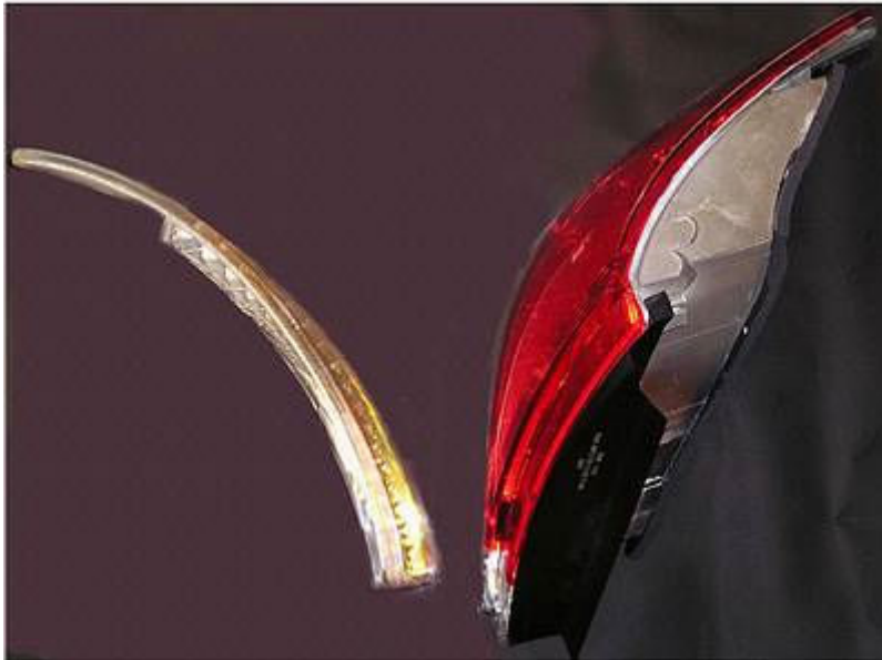
Abb. 9: Vergleich einer LED-basierten Leuchte (links) und einer konventionellen Leuchte mit gekrümmter Oberfläche
