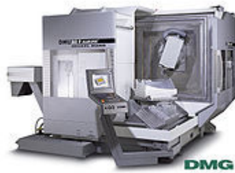
Abb. 11: CNC-Universalfräsmaschine mit 5-Achssteuerung
