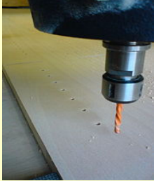
Slika 31: Bohren einer Lochreihe im System 32 auf einer Portalfräsmaschine
