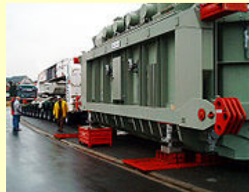
Slika 16: Hydraulikstempel zum Heben schwerster Lasten
