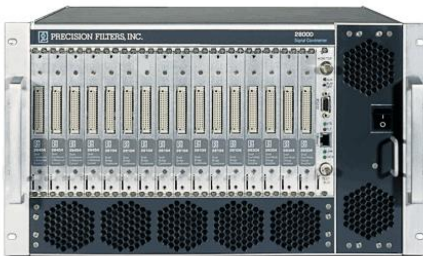
Slika 17: Primer naprave za obdelavo do 256 merilnih signalov.
