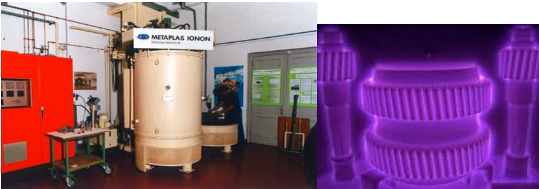
Slika 13: Zvonasta peč za nitridiranje v pulzirajoči plazmi METAPLAS IONON HZIW 600/100
