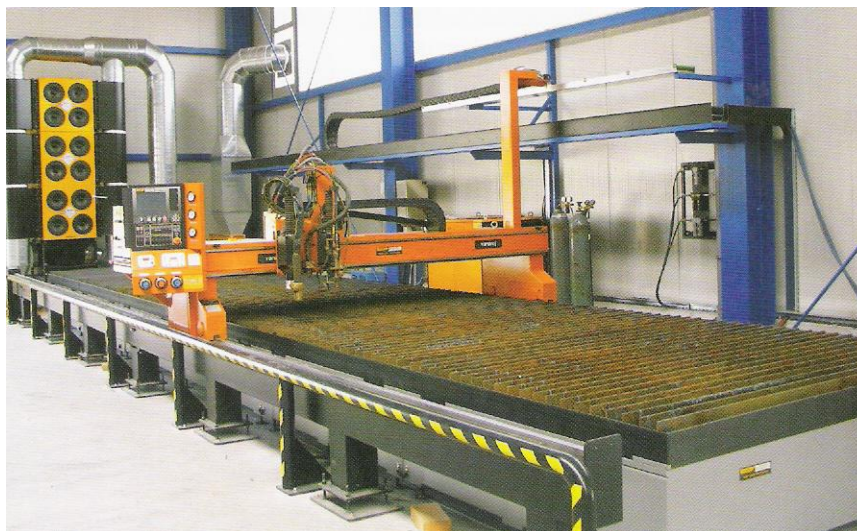
Slika 109: CNC rezalnik za avtogeno in plazemsko rezanje Vir: Varilna tehnika, 2009, 24
