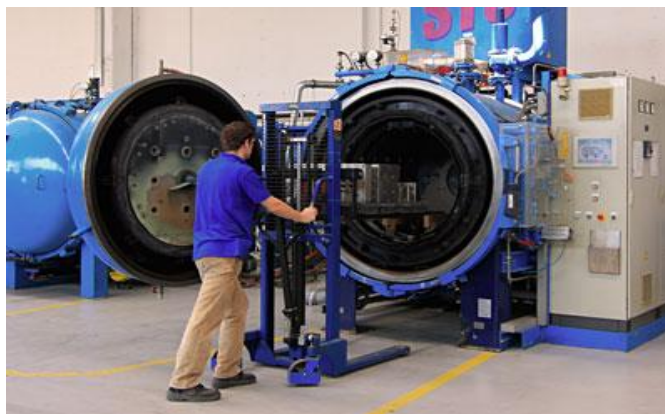
Slika 5: Zalaganje izdelkov v peč za vakuumsko kaljenje Vir: http://www.sc-nm.com/e-gradivo/prvi.html (01. 03. 2011)
