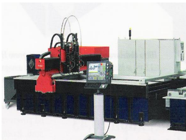
Slika 107: Stroj za rezanje z abrazivnim vodnim curkom
