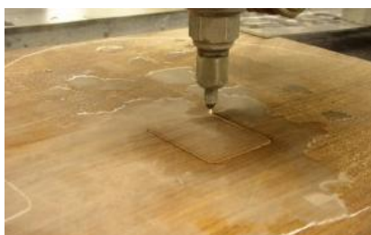
Slika 81: Prikaz rezanja masivnega lesa (perujski javor) z vodo
