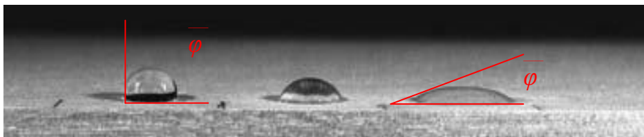
Slika 54: Izboljšanje omočenja lepilne površine z brušenjem Vir: Frihart, 2005, 232
