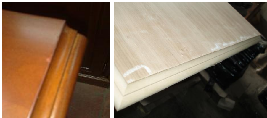
Slika 38: Vpliv otopelosti rezila na kvaliteto obdelave MDF plošče, oplemenitene s češnjevim furnirjem
