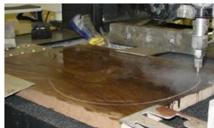
Slika 81: Prikaz rezanja masivnega lesa (perujski javor) z vodo
