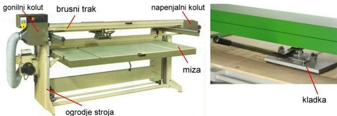
Slika 62: Horizontalni tračni brusilni stroj Vir: Prirejeno po Samstag K. et al., 1993, 80
