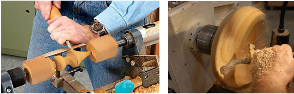
Slika 42: Vzdolžno in prečno struženje lesa Vir: Stegne, 2010, 59
