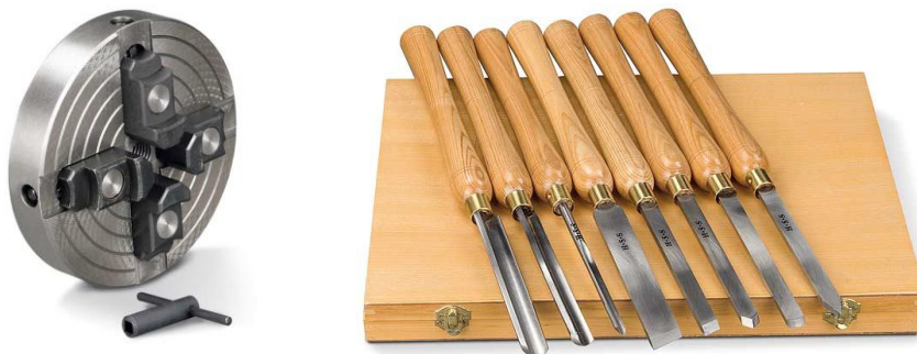
Slika 43: Vpenjalna čeljust in stružna dleta Vir: Stegne, 2010, 59
