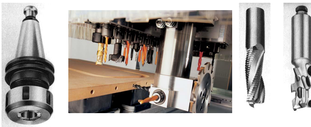
Slika 72: Vpenjalo, agregat in orodji za CNC obdelovalni center Vira: Lasten in katalog rezalnega orodja Hapro
