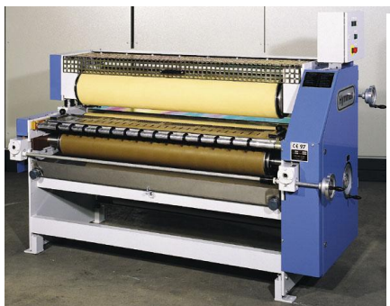
Slika 49: Stroj za valjčno nanašanje lepila Vir: Stegne, 2010, 87
