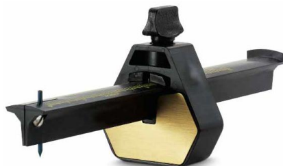
Slika 20: Črtalnik Vira: Likavec, A., 1983, 21
