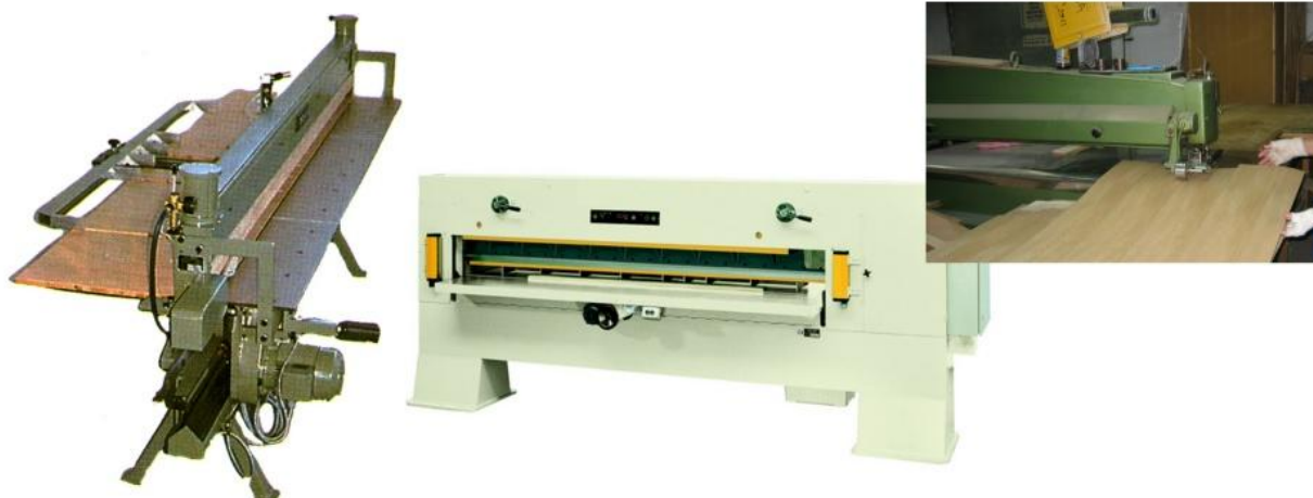
Slika 59: Paketni rezkalni stroj, paketne škarje in stroj za spajanje furnirja Vira: Samstag, K. et al., 1993, 100 in lasten
