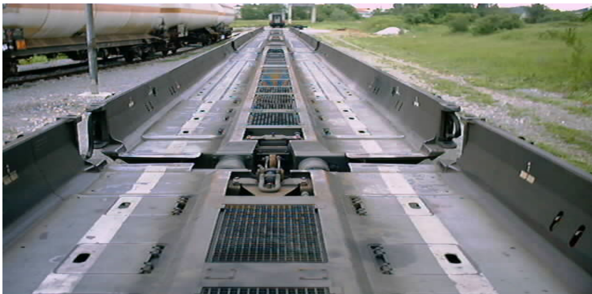
Slika 30: Talna površina specialnih tovornih vagonov serije Saadkms Vir: Lasten
