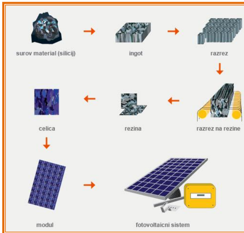
Slika 39: Proces izdelave fotovoltaičnega modula in fotovoltaičnega sistema Vir: Sopori, 2006
