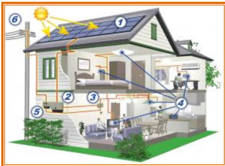
Slika 37: Shematski prikaz delovanja solarne elektrarne Vir: Gorenjske elektrarne, 2010
