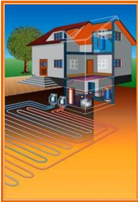
Slika 51: Primer delovanja toplotne črpalke, ki izkorišča akumulirano zemeljsko energijo kot vir toplote
