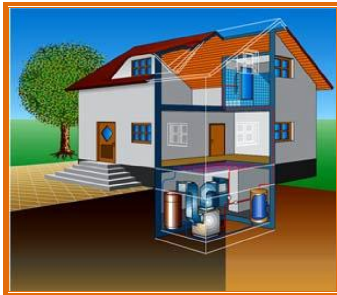
Slika 50: Primer delovanja toplotne črpalke, ki izkorišča zrak kot vir toplote Vir: Bajs, 2010
