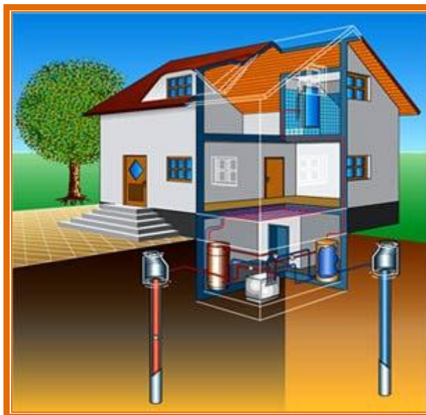
Slika 53: Primer delovanja toplotne črpalke, ki izkorišča podtalnico kot vir toplote Vir: Bajš, 2010
