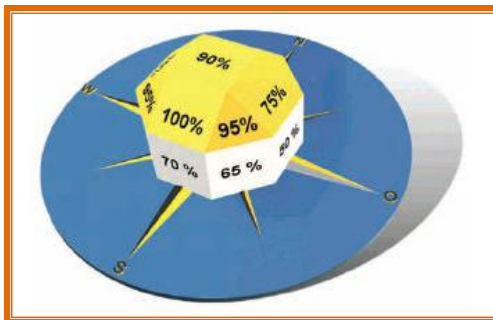
Slika 45: Optimalna postavitev solarnih modulov (usmeritev in nagib) ter vpliv teh usmeritev in nagiba na izkoristek sončne energije Vir: Šrot, 2007
