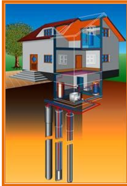
Slika 52: Primer delovanja toplotne črpalke, ki izkorišča akumulirano energijo kamnin kot vir toplote
