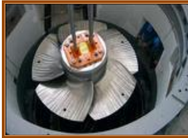
Slika 81: Propelerska vodna turbina Vir: Mulc, 2010
