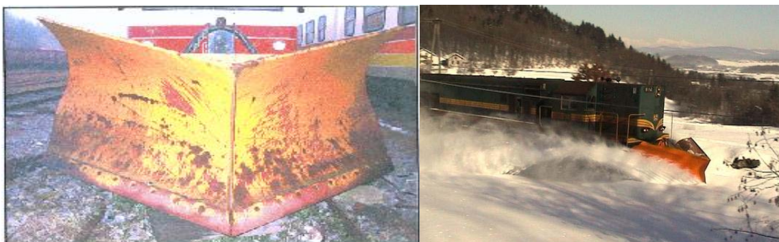
Slika P-3-1: Snežni čelni plug na potniški kompoziciji in križarka s čelnim nadtirničnim plugom
