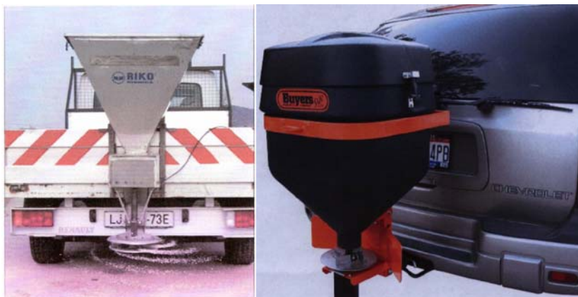
Slika 42: Priključni samodejni posipalnik na stranici lahkega tovornega vozila in vlečni napravi osebnega vozila
