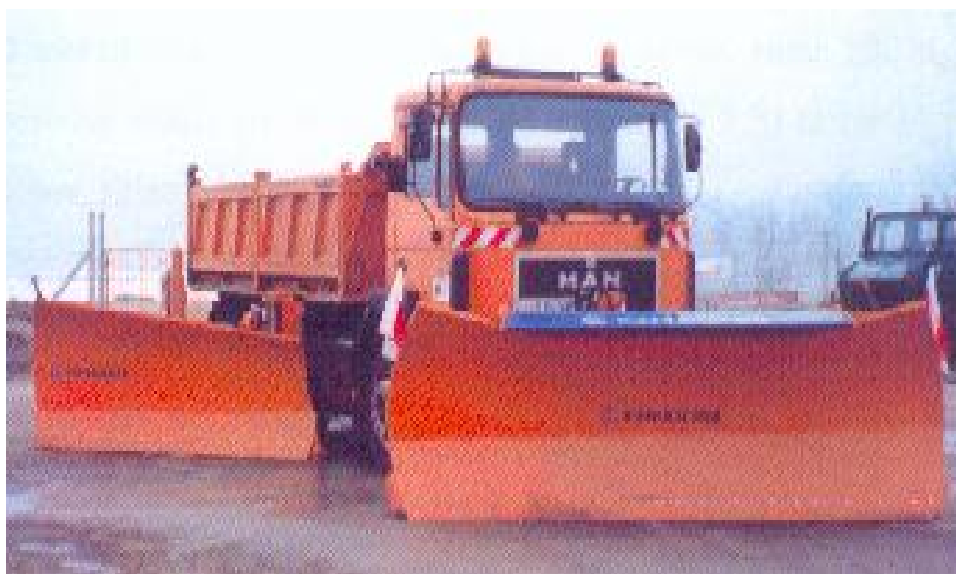
Slika 27: Čelni in bočni plug
