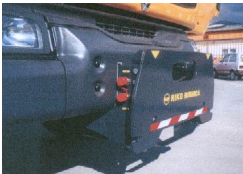
Slika 22: Priključna plošča na tovornem vozilu s hidravličnimi hitrimi spojkami, namenjena hitri menjavi različnih delovnih priključkov
