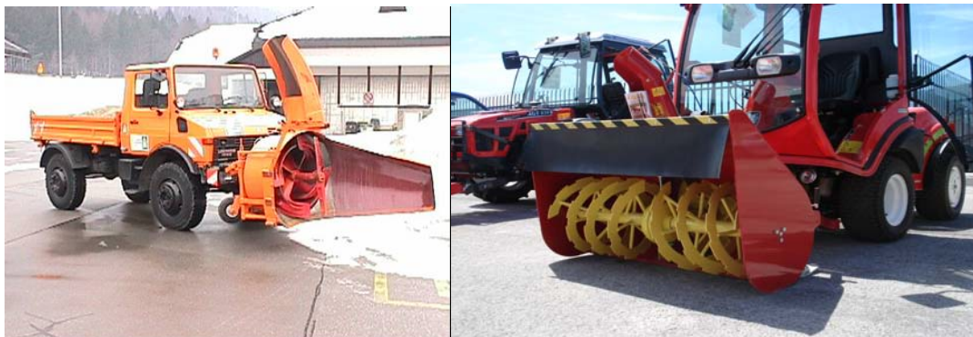
Slika 44: Kolutni (levo) in valjni (desno) snežni odmetalnik Vir: Lasten
