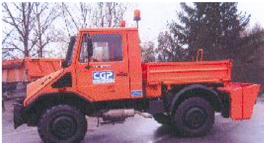
Slika 34: Priključni posipalnik Vir: Lasten
