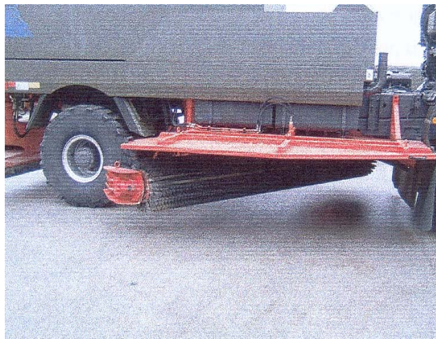
Slika 45: Bočni snežni pometalnik z elektromotornim pogonom Vir: Lasten
