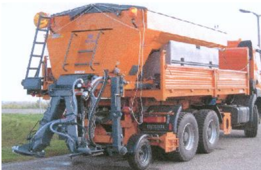
Slika 38: Samodejni posipalnik s pogonom preko sledilnega kolesa in dvema razdelilnima krožnikoma ter sledilnim kolesom za pogon posipalnika Vir: Lasten
