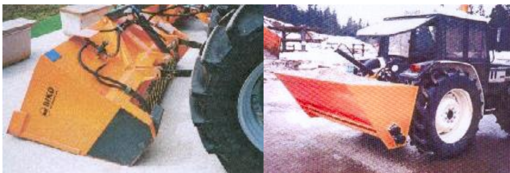
Slika 37: Samonakladalni posipalnik v položaju za polnjenje in v delovnem položaju Vir: Lasten
