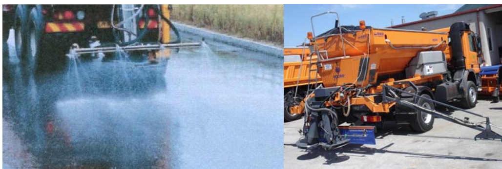
Slika 18: Škropljenje s sredstvi za taljenje in škropilna naprava velike širine Vir: Lasten
