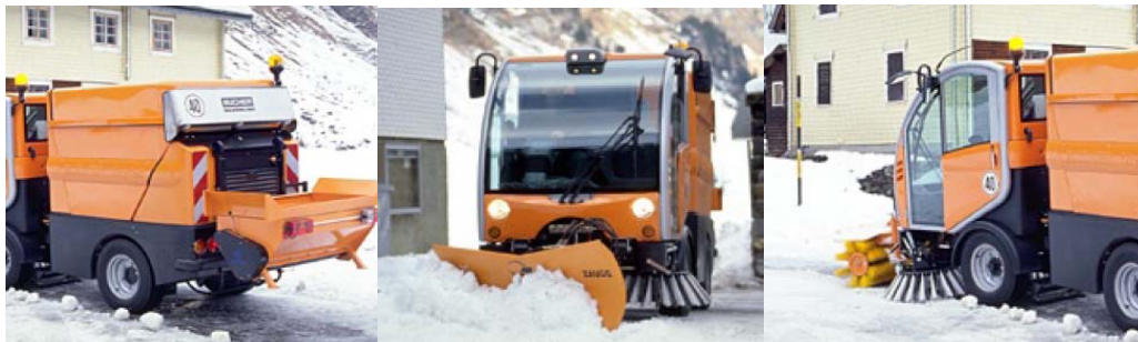
Slika 46: Večnamenski lahki delovni stroj, opremljen za zimsko službo (čelni snežni plug, priključni posipalnik, snežne metle)
