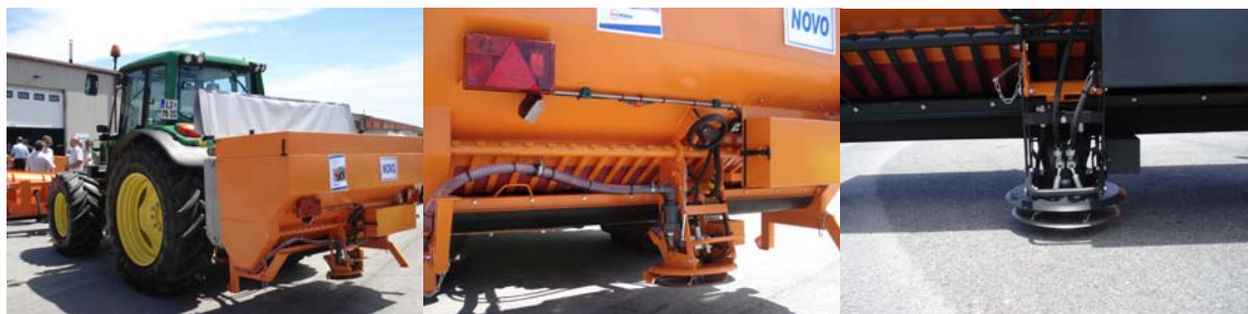
Slika 35: Priključni posipalnik z razdelilnim krožnikom Vir: Lasten
