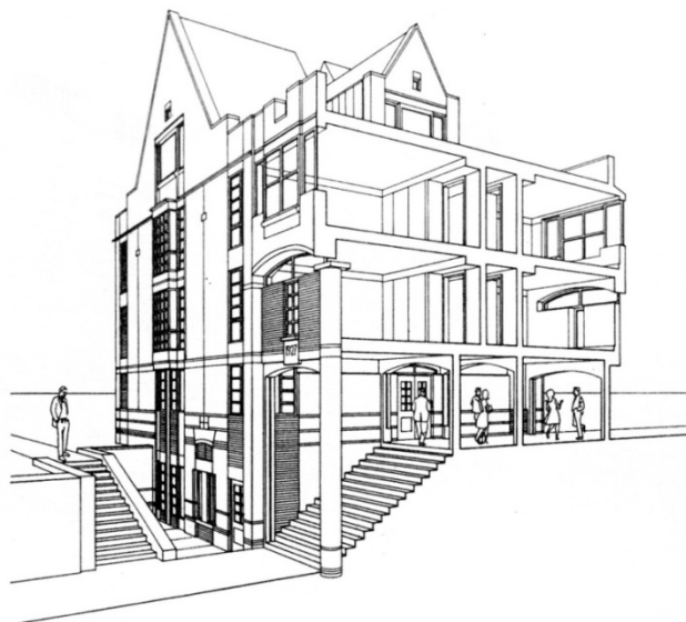
Slika 35: Dvobežiščna perspektivna projekcija (Vir: Laseau, 2000, 58)
