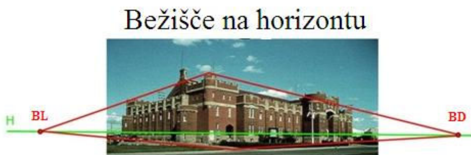
Slika 34: Dvobežiščna perspektivna projekcija. Bežišči na horizontu (Vir: www.hunter.cuny.edu/cs/Faculty/Stamos/3D_f03.html ) (29. 5. 2009)
