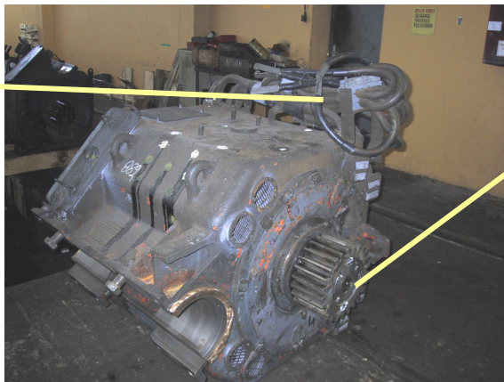
Slika 88: Vlečni motorji dizelektromotorne lokomotive Vir: Lasten.
