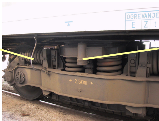
Slika 73: Vozni podstavek; omejilnik vertikalnega nihanja, električna vez za izenačitev potencialov Vir: Lasten.
