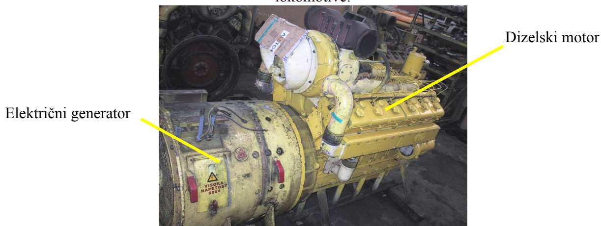
Slika 89: Sklop dizelskega motorja in generatorja napetosti Vir: Lasten.
