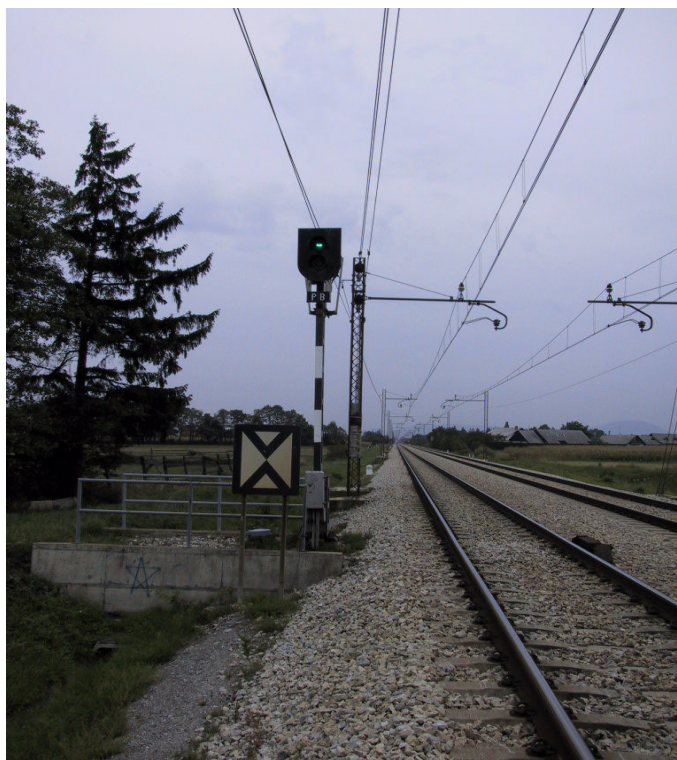
Slika 14: Svetlobni signal, nameščen ob progi, na levi strani proge Vir: Lasten.
