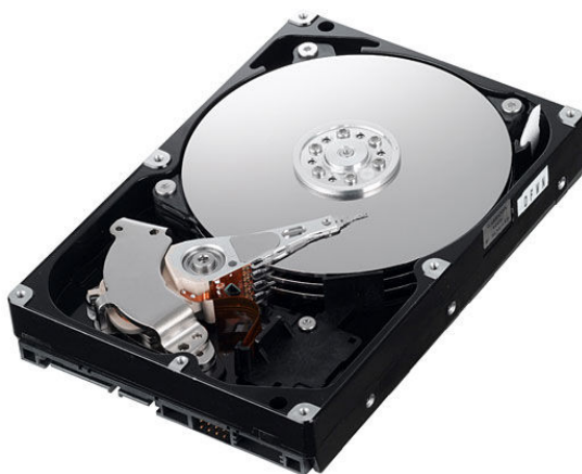
Slika 24: Notranjost trdega diska Vir: http://gizmodo.com/ (13. 6. 2010)
