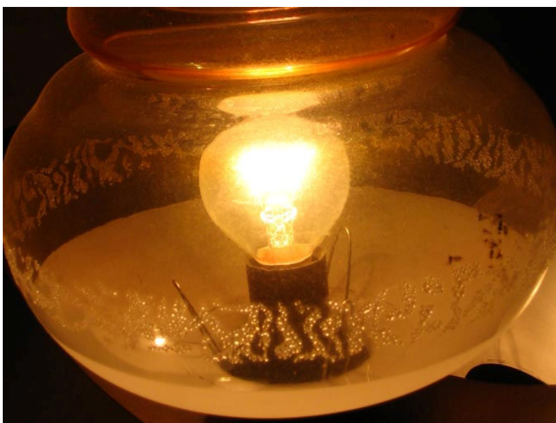
Slika 55: Žarilna nitka ima nizko temperaturo svetlobe, zato je njena barva rumenkasta Avtorica fotografije: Tanja Lazar, Vir: lasten
