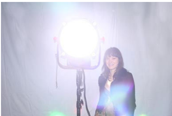
Slika 96: Obločnice imajo do sedemkrat večji svetlobni izkoristek Vir: lasten
