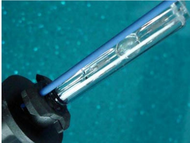
Slika 97: Manjše ksenonske obločnice najdemo tudi v avtomobilskih žarometih
