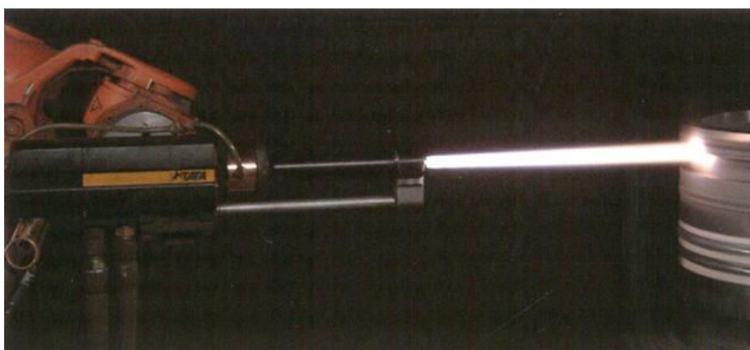
Slika 200: Visokohitrostno plamensko nanašanje prevlek
