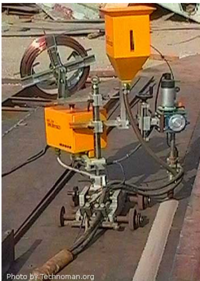
Slika 178: Prikaz varjenja pod praškom
