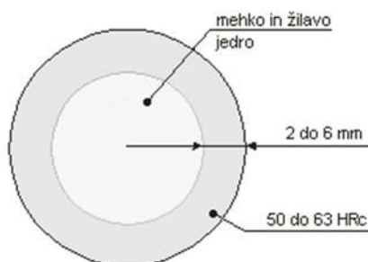
Slika 118: Zakaljena globina pri površinskem kaljenju Vir: Prirejeno po: Leskovar, 1978, 222
