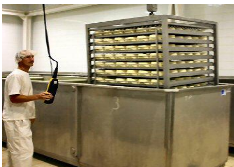
Slika 45: Soljenje s paletami za potapljanje
