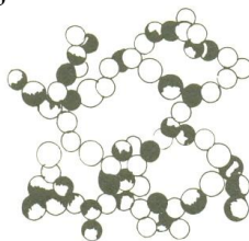
Slika 16: Koagulacija mleka s himozinom – encimska koagulacija
