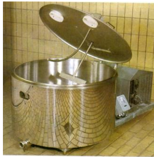
Slika 10: Hladilni bazen s kompresorsko enoto
