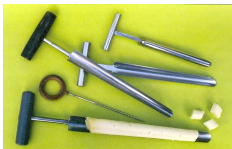
Slika 49: Sirarski svedri, s katerimi spremljamo potek zorenja sira
