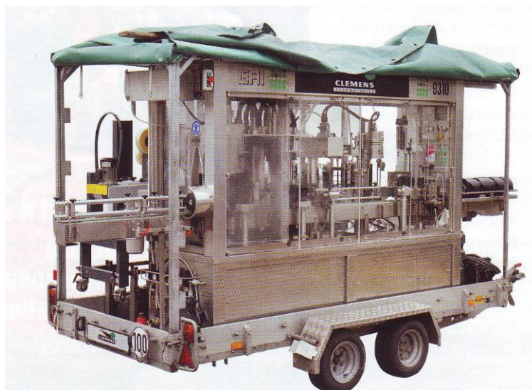
Slika 101: Prevozna etiketirka zmogljivosti 2500 stek./ura Vir: Prospekt podjetja Bertoloso
