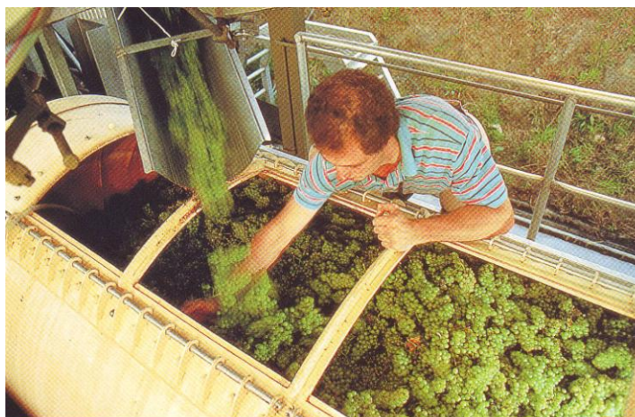
Slika 105: Polnjenje celega grozdja v horizontalno batno stiskalnico
