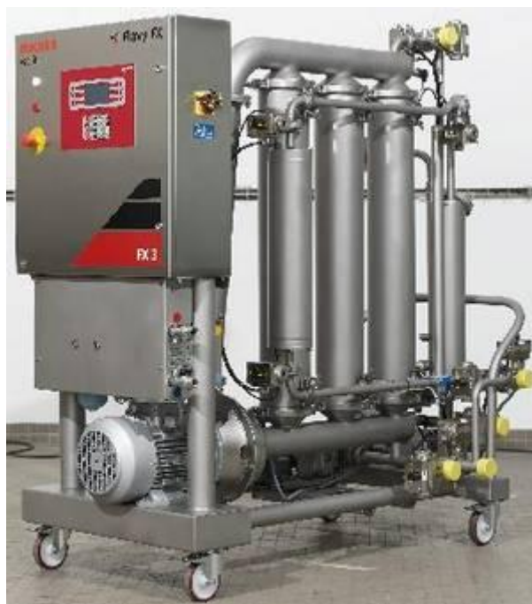
Slika 117: Tangencialni filter Vir: Prospekt podjetja Seitz-Schenk
