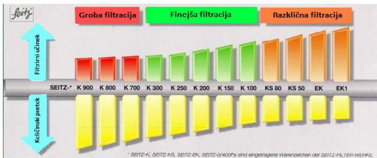
Slika 148: Shematični prikaz več možnosti filtriranja različno motnih vin s filtrskimi ploščami, različne, a ustrezne poroznosti za posamezno fazo nege vin
