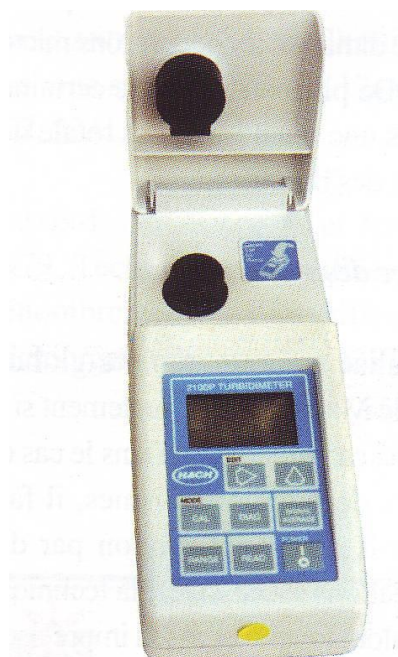
Slika 88: S turbidimetrom (nefelometer) ugotavljamo motnost vina Vir: Serrano, 1998, 13
