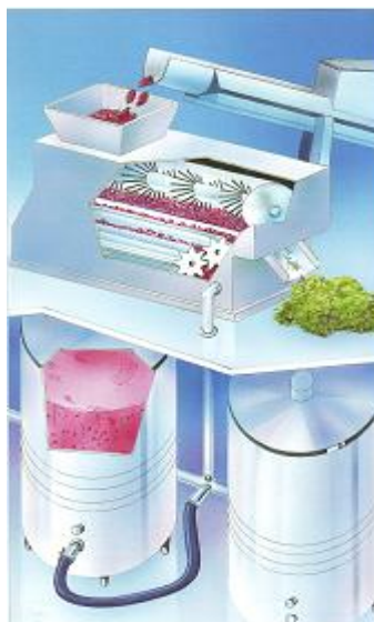
Slika 84: Idealna razporeditev strojev v sprejemnici in predelavi grozdja Vir: Priewe, 1998, 71
