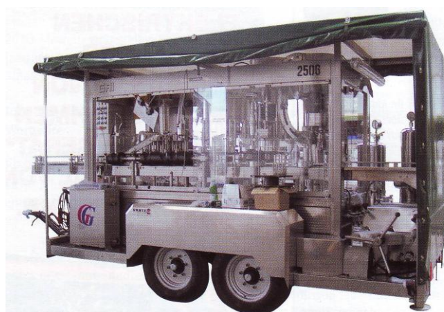
Slika 100: Prevozen polnilec zmogljivosti 2500 stek./ura Vir: Prospekt podjetja Bertoloso
