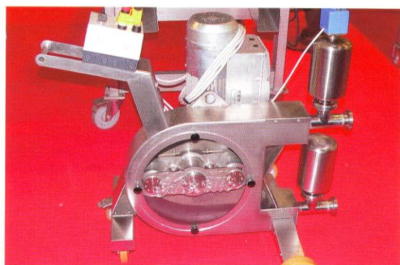
Slika 106: Enostavna črpalčka za vino in drozgo lahko teče »na suho« in potrebuje malo vzdrževanja (levo), črpalčka za vino na impeler, ki lahko zelo kratek čas teče na »suho« (desno)
