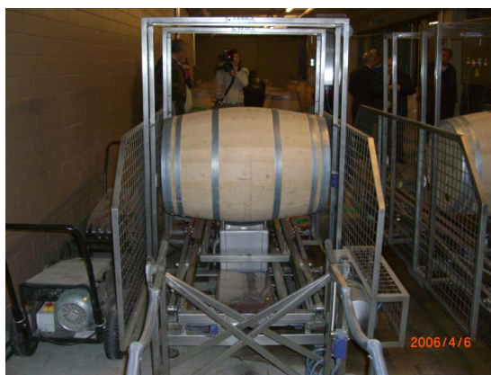
Slika 124: Strojno pranje soda
