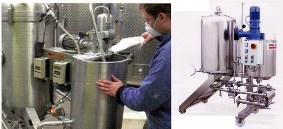
Slika 109: Prikaz sipanja filtrirnega sredstva v naplavni filter (levo), naplavni filter (desno) Vir: Schandelmaier, 2009, 50
