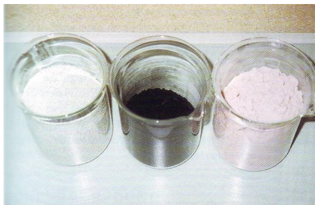
Slika 145: Napačno skladiščen bentonit, aktivno oglje ali kremenčeva pena je pogosto vzrok tujim vonjavam vin
