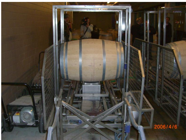
Slika 205: Naprava za avtomatsko pranje barikov Vir: Lasten
