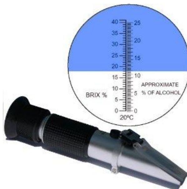
Slika 33: Ročni refraktometer za določanje sladkorne stopnje jagodnega soka
