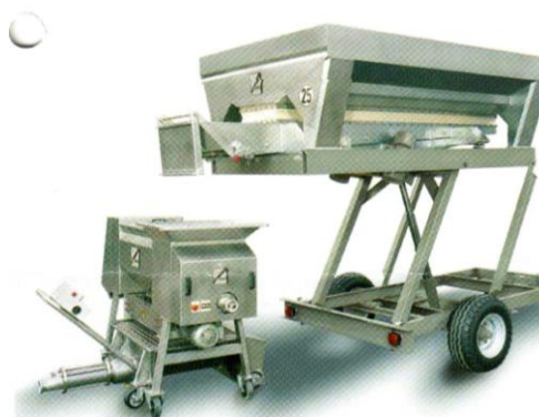
Slika 37: Prikolice, opremljene na dnu s polžem ali s tekočim trakom za razkladanje, omogočajo kakovostno razkladanje na nižji nivo sprejemnega korita Vir: Prospekt podjetja AMOS
