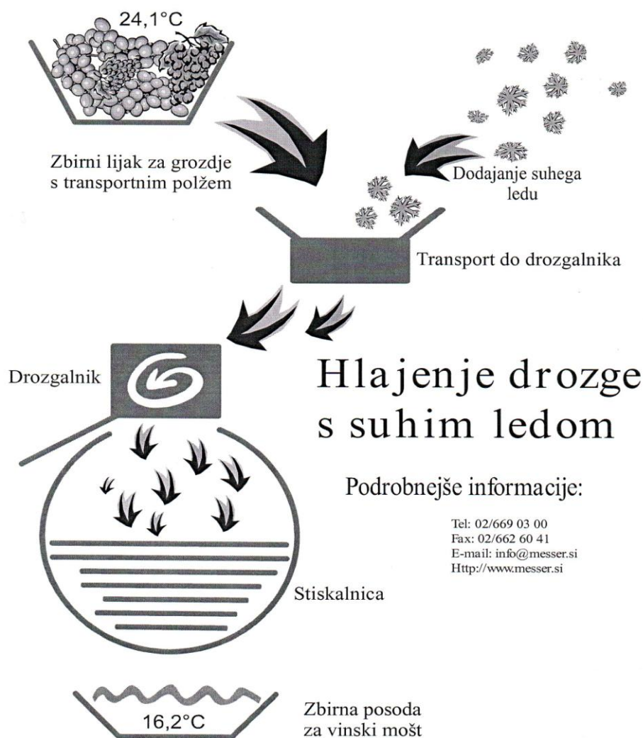
Slika 62: Hlajenje drozge s suhim ledom Vir: Prospekt podjetja MESSER
