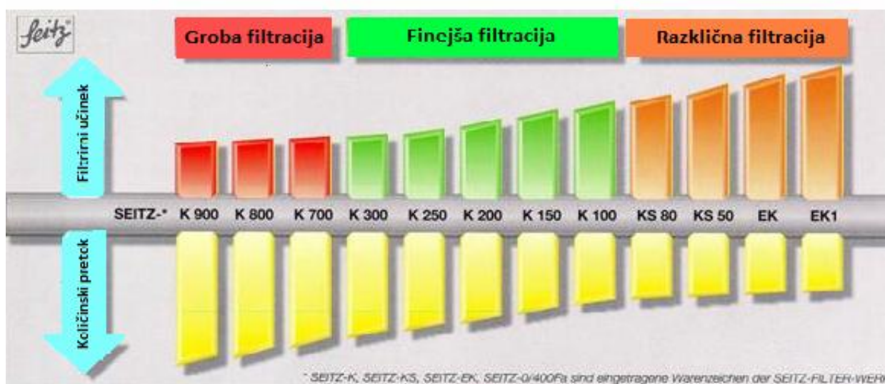
Slika 113: Prikaz stopenj filtriranja vin v povezavi s pretokom in poroznostjo vrste filtrskih plošč
