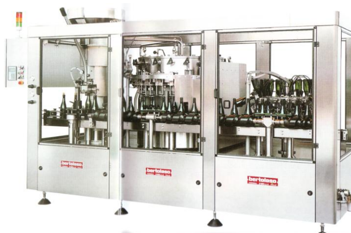
Slika 99: Monoblok iz izplakovalca, polnilca in zamašilca Vir: Prospekt podjetja Bertoloso
