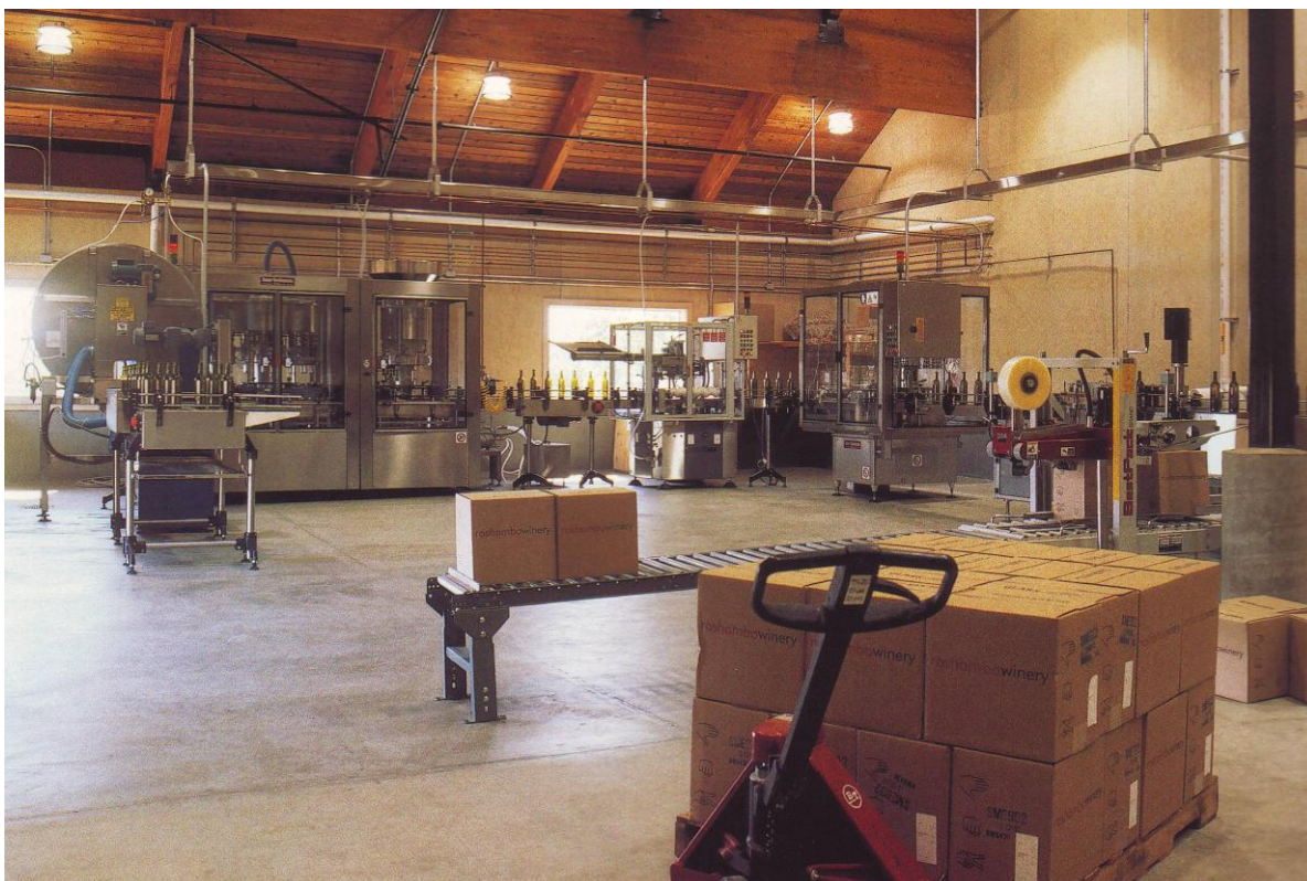
Slika 95: Sodobna, avtomatska polnilnica za vino, vključno s paletizacijo
