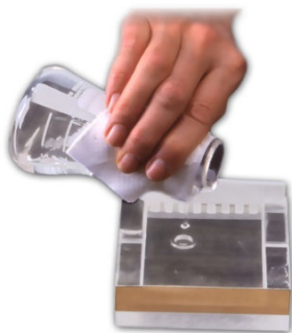
Slika 61: V model prilijemo ohlajen – mlačen gel ter ga z rahlim obračanjem razporedimo po celotni površini.
