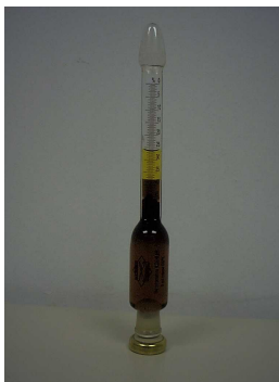
Slika 78: Butirometer za določanje maščob po Gerber-ju v mleku in mlečnih izdelkih Vir: Hmelak Gorenjak, 2007
