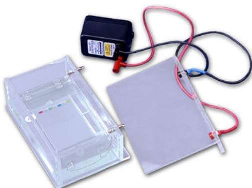
Slika 63: V elektroforezno kadičko vstavimo gel tako, da so mesta z vzorci bliže črni (negativni) elektrodi. Prilijemo pufer in zapremo kadičko s pokrovom ter opišemo spremembe.
