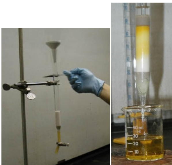
Slika 46: Enostaven primer kolonske kromatografije Vir:
