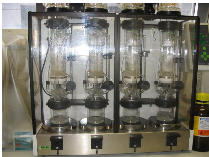
Slika 79: Sestavni deli klasične in sodobne aparature za določanje maščob po Soxhletu (a – hladilnik, b – ekstraktor, c - tulec z vzorcem, d – bučka) Vir: Hmelak Gorenjak, 2007
