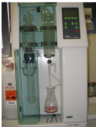
Slika 72: Sodobna destilacijska naprava za določanje beljakovin po Kjeldahlu
