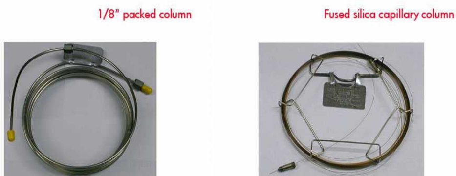
Slika 53: Vrste kolon, ki se uporabljajo v GC - tehniki
