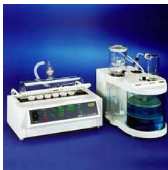
Slika 69: Sodobna aparatura za moker sežig z enoto za nevtralizacijo strupenih plinov Vir: http://www.speciation.net/Appl/Techniques/technique.html?id=2477 (3. 9. 2009)
