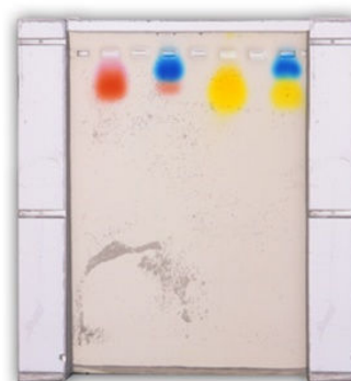
Slika 64: Napetost nastavimo na 50–100 V ter pustimo približno 5 - 10 min. Ko prične barvilo potovati skozi gel, izključimo električni tok in priključimo električni tok.
