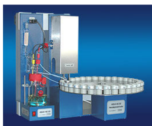
Slika 67: Aparatura (titrator) za določanje vsebnosti vode po Karl Fischer-ju
