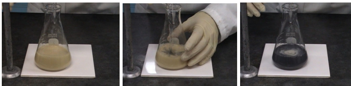
Slika 12: Prikaz določitve \text{Cu}^{2+} z indirektno titracijo.
