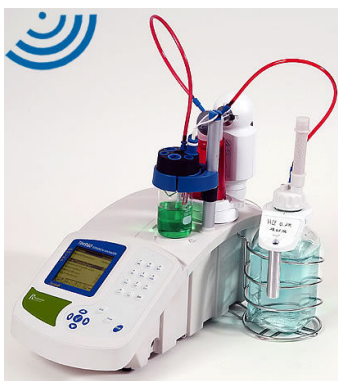
Slika 80: Določanje peroksidnega števila tudi s sodobnim titratorjem
