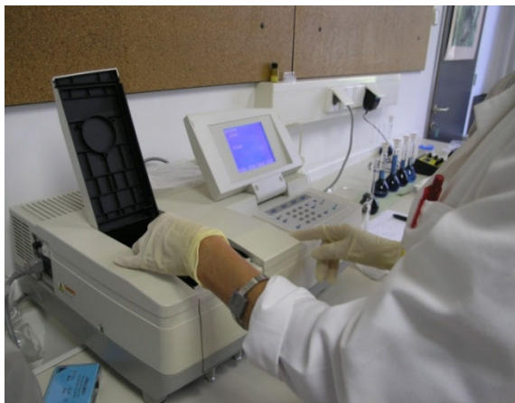
Slika 36: Prikaz dela na spektrofotometru Vir: A. Hmelak Gorenjak
