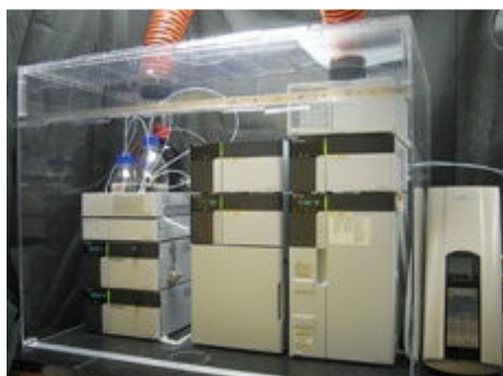
Slika 90: Za določanje aditivov se pogosto uporablja tekočinska kromatografija visoke ločljivosti
